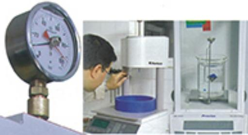
Ayrıca melt flow index testi uygulanarak maddenin, erime akış hızı tespit edilerek istenilen özellikte olup olmadığı kontrol edilmektedir.
